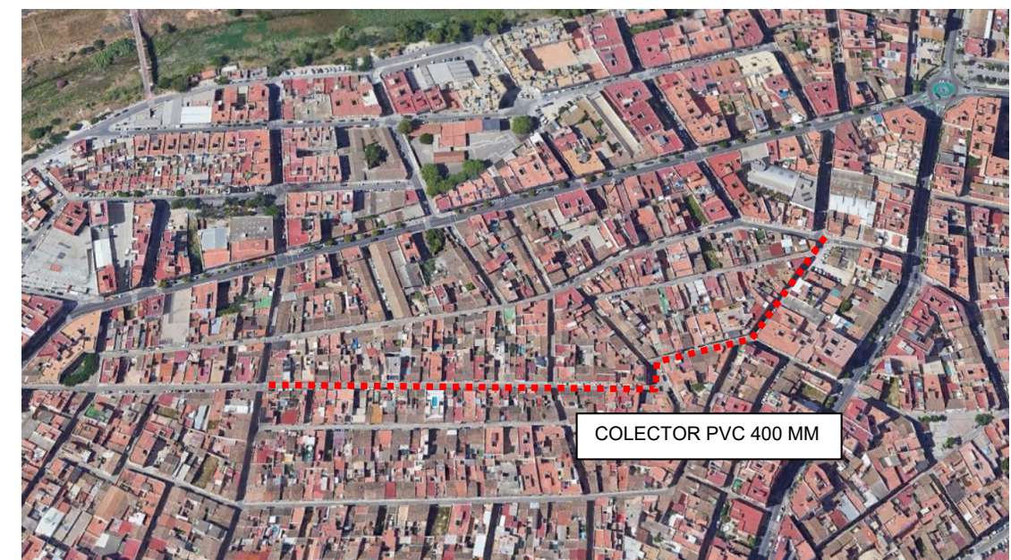
Figura nº 2. Colector de saneamiento.
